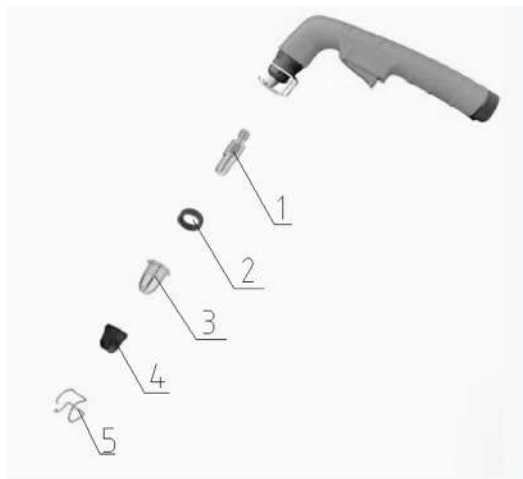
FIG. 5 Diagrama esquemático de la estructura del soplete de corte
