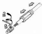
Figura 4-3 Conjunto de conexión rápida
