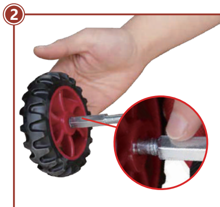
Paso 2: Fije el tornillo y la tuerca a la rueda, dejando un espacio de 2 mm hacia afuera.
